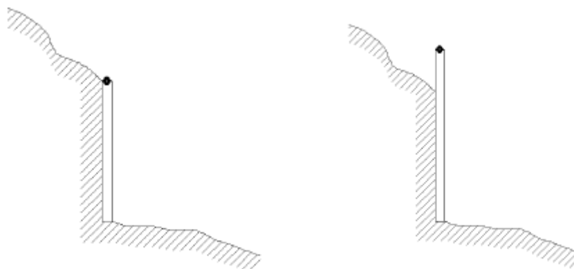
Mur de contenció. Es captura per la cota més alta
